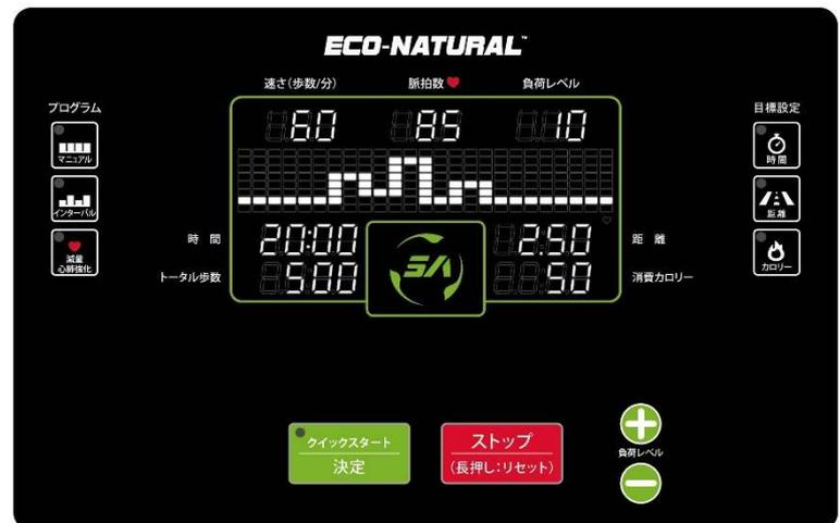
設定モードでは目標項目（時間、距離、カロリー）の設定個人データ（年齢、体重）の入力を行います。年齢、体重を入力しますと、トレーニングの目標脈拍目安が表示されます。
