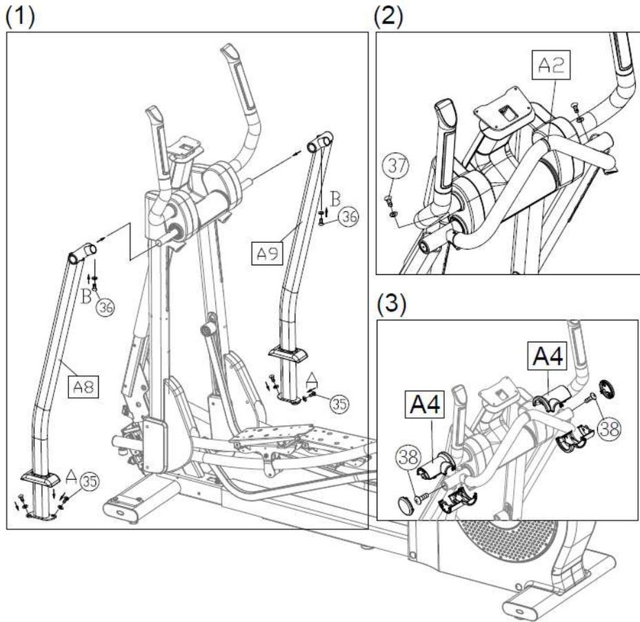
(6-1)挿入 左と右の支持チューブ(A8) (A9)を車軸領域とベースに入れ、ねじ(35)で緩く所定の位置に固定します(36)
