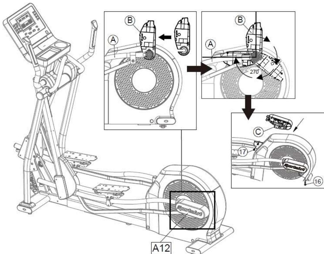
ペダルアームを下の図に示す位置まで回転させ、カバーBをつけて時計回りに270度回転させます。
