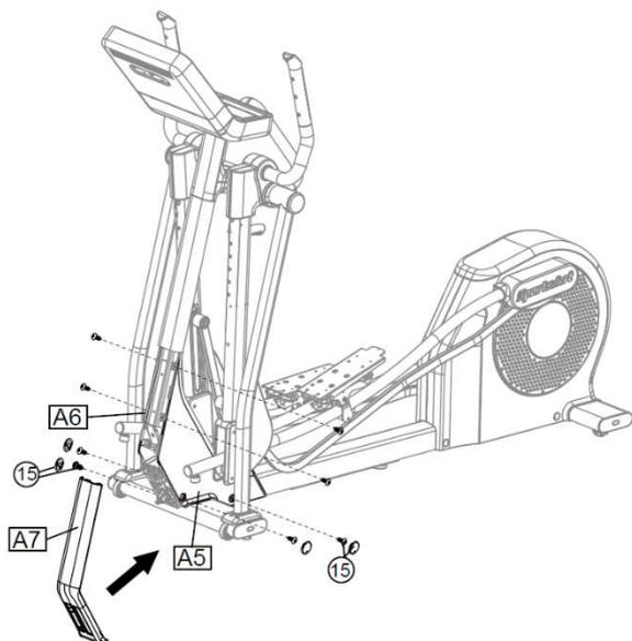
左/右の台座カバー(A5)(A6)をスクリュー(15)を使用してメインフレームに固定し、丸型スクリューキャップ(15)とフロントベースカバー(A7)を付けます。
