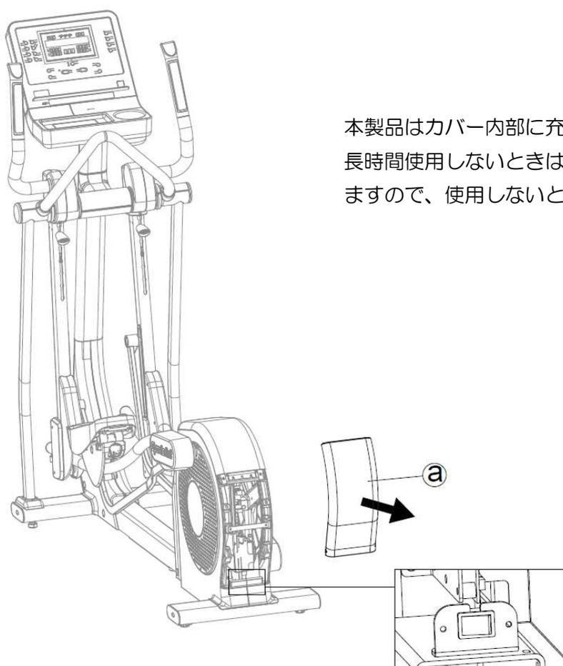
本製品はカバー内部に充電バッテリーを搭載しています。長時間使用しないときは、バッテリーの機能低下にもつながりますので、使用しないときは電源をオフにしてください。
