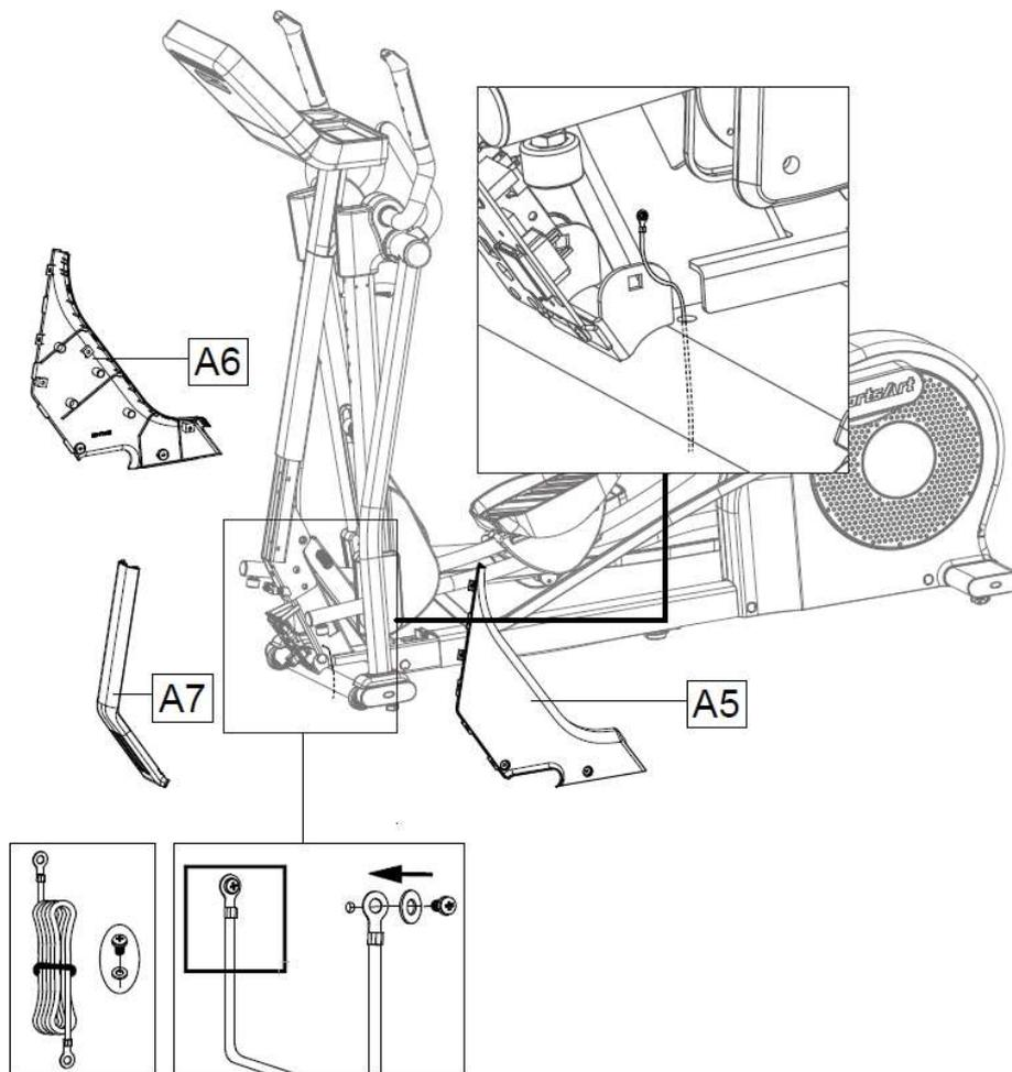
感電や電流漏れを避けるために、製品に囲まれた追加のアース線が付属しています。安全上の理由から、必ずアース線を機器に接続してください。
