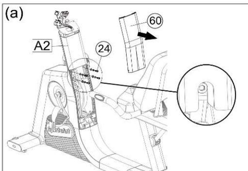
(a) カバー (60) を取り外します。ハンドルポスト (A2) を取り付けし、ボルト (24) で固定します。
