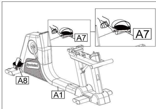
付属のレンチ(15mm)でペダルを取付けます。
