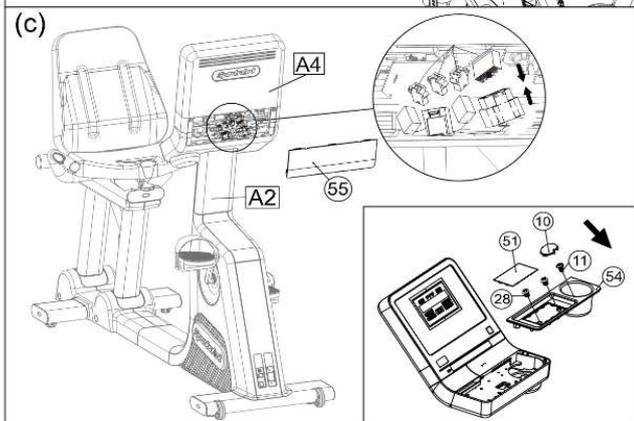
(c) リアカバー (55) を取り外し、コンソール (A4) のケーブルを接続します。コンソールマスト (A2) のケーブルに接続した後に、リアカバー (55) を取り付けます。ロック (52) とネジ (28) (11) をセットします。スリップパッドと丸ネジキャップ (10) を順番に取り付けます。
