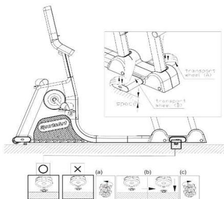
バイクの前後左右には床面とのガタツキを調整するために水平調整アジャスターがついています。
