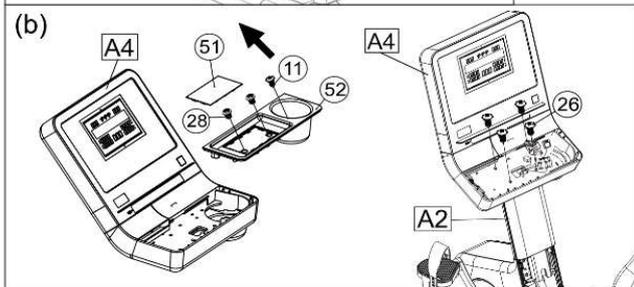
(b) コンソール (A4) に付いている滑り止めパッド (51) を取り、ボルト (28) (11) とドリンクホルダー (52) を取り外します。
