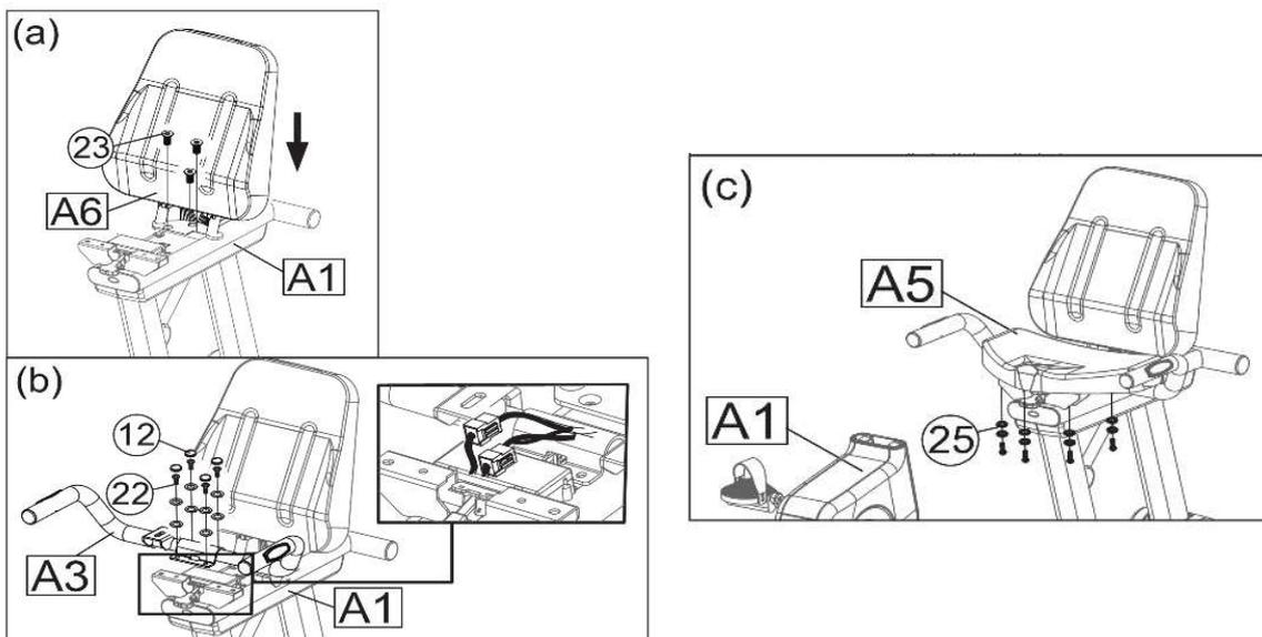
(a) メインフレーム (A1) に背もたれシート (A6) を取り付け・固定します。
