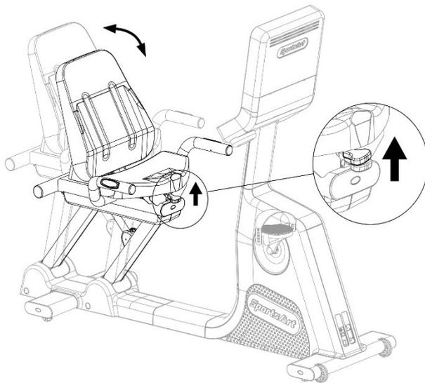
シート直下のレバーを引き上げるとシートが前後に動きます。乗りやすいポジションでエクササイズするようにしてください。ペダルが一番遠いポジションで、膝が伸び切らないところが最適なポジションです。
