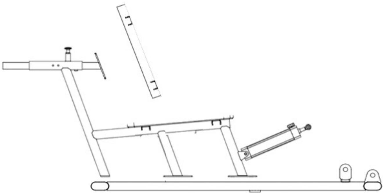
② 座面フレーム・背パットフレームを取り付けます
