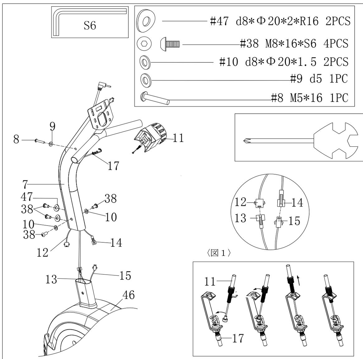
1. ハンドルバーポスト (7) に本体メインフレーム (46) から出ている負荷調整ワイヤー (17) を通します。脈拍センサーコード (12) と脈拍センサーコード (13) を接続し、速度センサーコード (14) と速度センサーコード (15) を接続し、ハンドルポスト (7) を本体メインフレームに差し込みます
