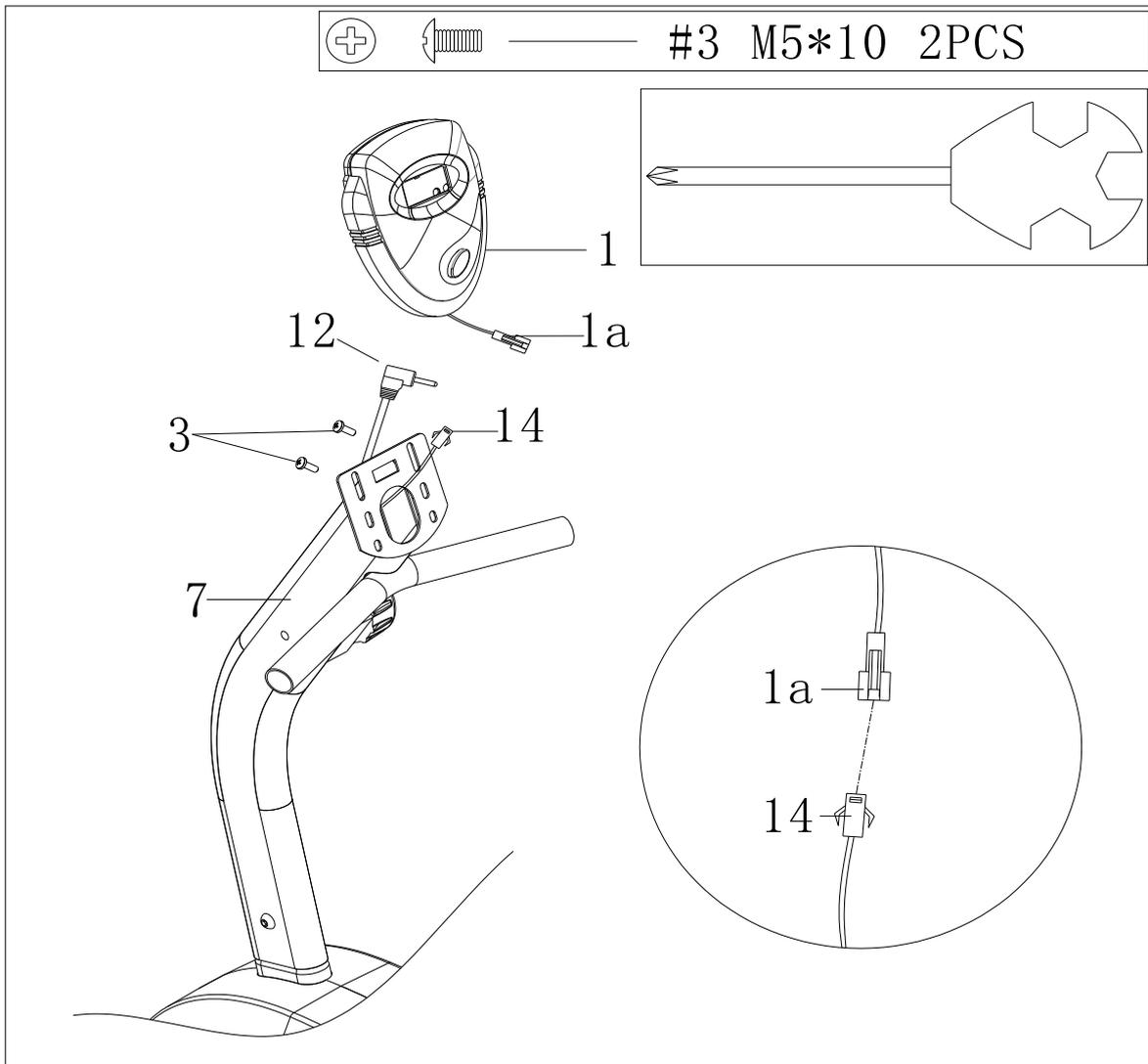
1. ディスプレイ (1) のセンサーコード (1a) と速度センサーコード (14) を先に接続します。そして、ディスプレイ (1) をハンドルバーのポスト (7) にボルト (3) で固定します。
