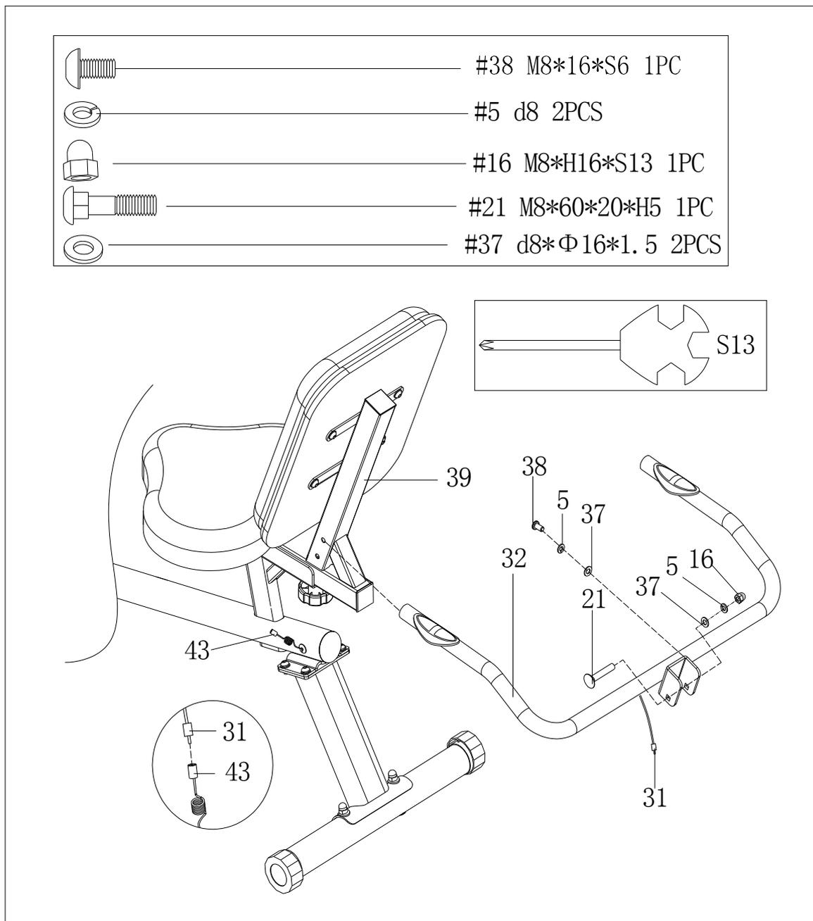
1. ハンドルバー (32) をボルト (21)、スプリングワッシャスプリング (5)、ワッシャー (37)、キャップナット (16) でサドルフレーム (39) に取り付けます。
