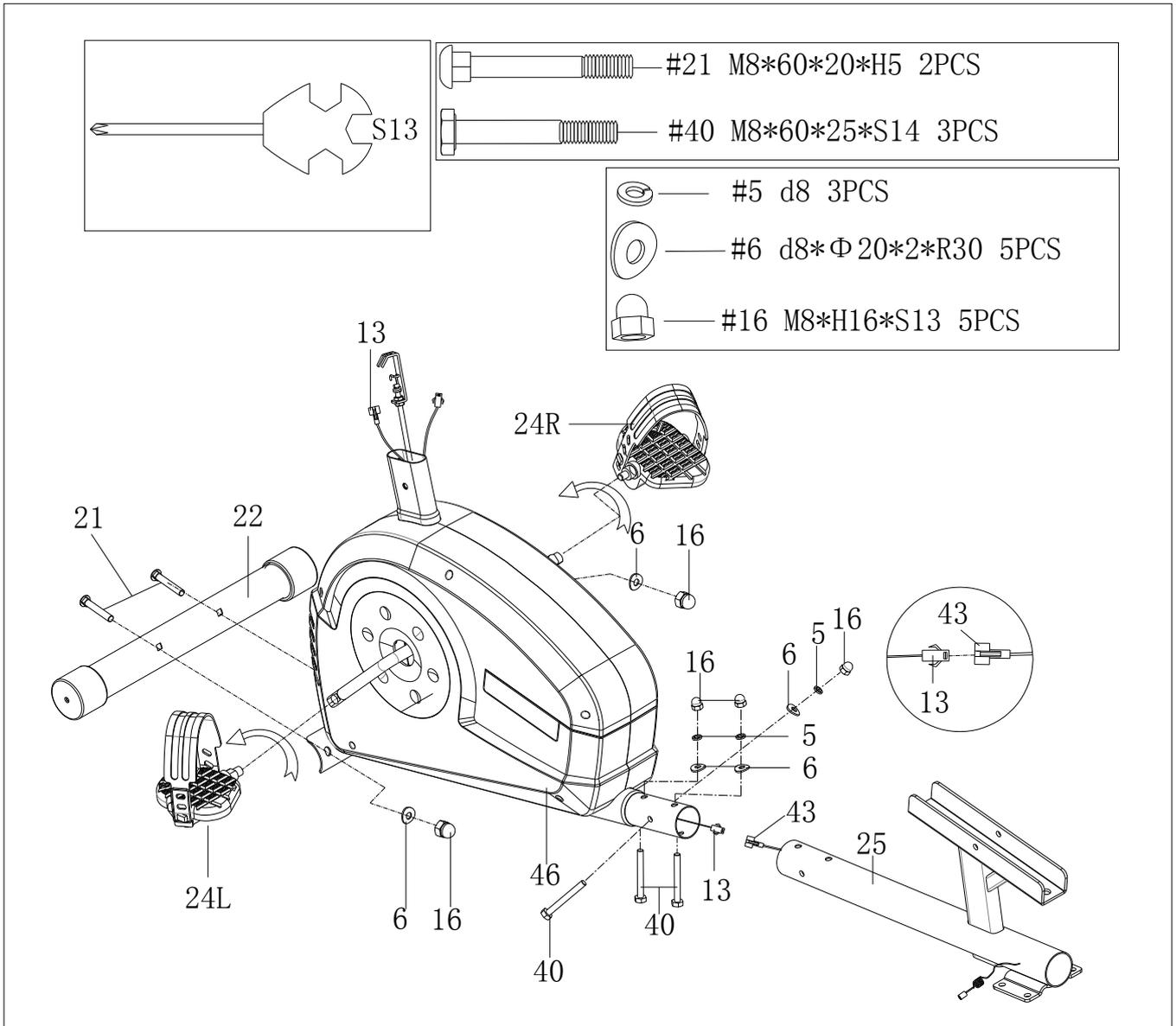
1. スクエアネックボルト (21)、ワッシャー (6)、およびキャップナット (16) を使用して、フロントスタビライザー (22) をメインフレーム (46) に取り付けます。
