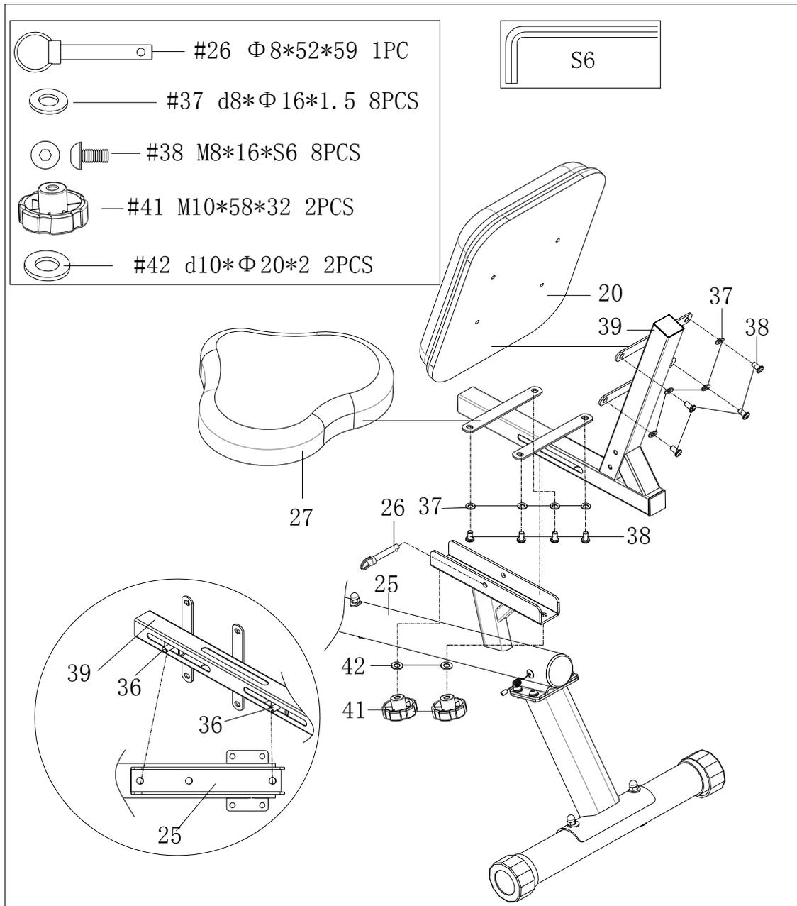
1. サドルフレーム (39) をノブ (41) とワッシャ (42) でリアメインフレーム (25) に取り付けます。リアメインフレーム (25) に調整ピン (26) を挿入します。
