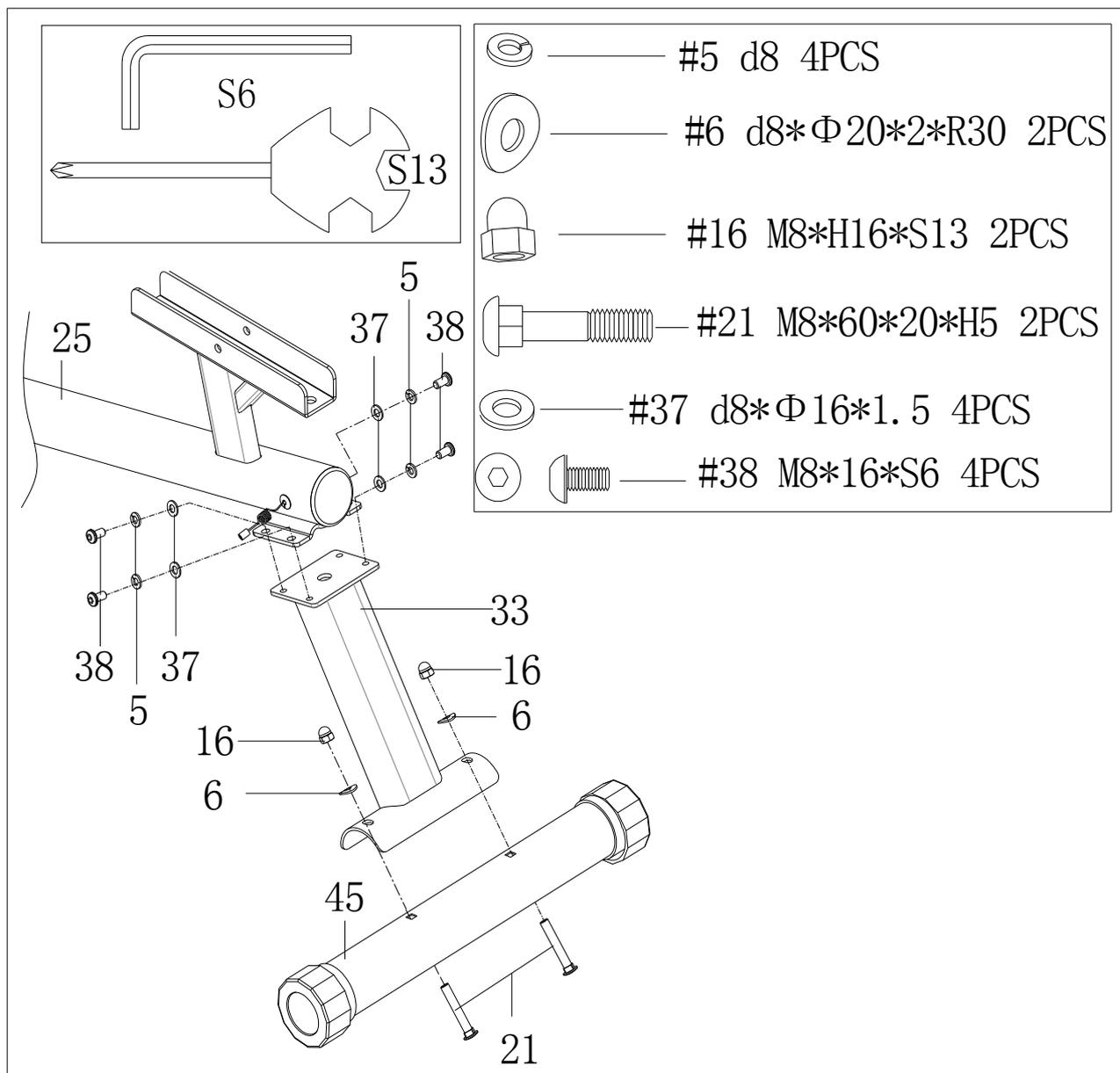
1. スクエアネックボルト (21)、ワッシャー (6)、およびキャップナット (16) を使用して、リアスタビライザー (45) をリアアンダーポスト (33) に取り付けます。
