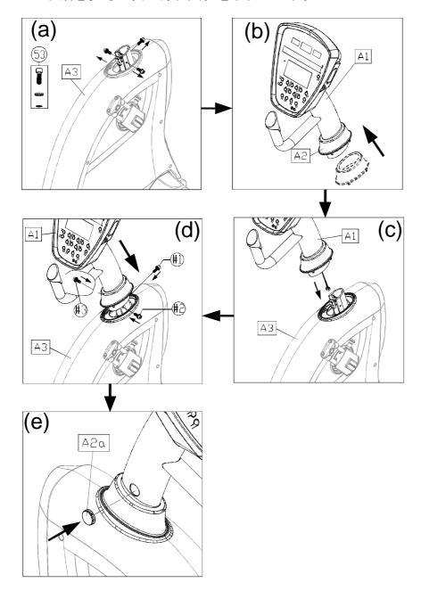
① aのように、仮止めされているボルト、ワッシャーを取り外します。
