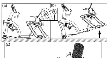
マシンを移動する時は、マシン前方に移動用 キャスターが付いていますので、左図のよう に持ち手を持って、後ろ側を持ち上げた状態 で、移動してください。
