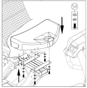
②左図のように、取付位置に合わせ、ボルトとワッシャーで、固定します。
