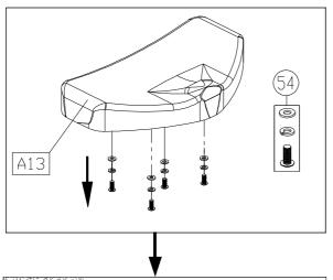
①シートを取付けます。あらかじめ仮止めしてある ボルト、ワッシャーを外します。
