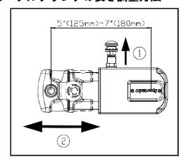
C521MⅡはクランクの長さの調整が可能です。 図のようにピンを持ち上げて、ロックフリーの状態に して、お好みの位置に合わせてください。 ※125 mm~180 mmの範囲内で、調整可能です。
