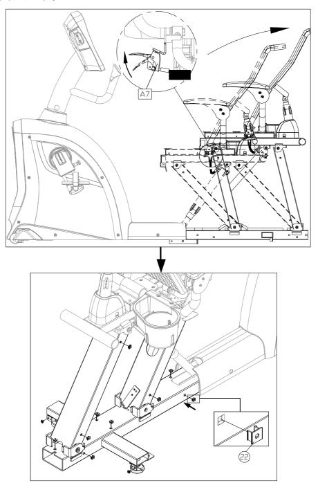
①シート前後調整のシリンダー (A7) を引っ張り、シートを遠い状態にします。 上図の下側の図のように、本体フレームにネジ用のソケット (No.22) を挿入します。 ※生産の工程で、あらかじめ付いている場合があります。
