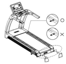
付属のランニングベルト調整用のレンチをベルト調整箇所(上図)のボルトに差込みランニングベルトを一旦緩めます。
