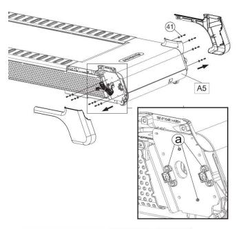
② 支柱固定部のカバーを外します。 左右4組のボルト、ワッシャー[部品 40] を外します。
