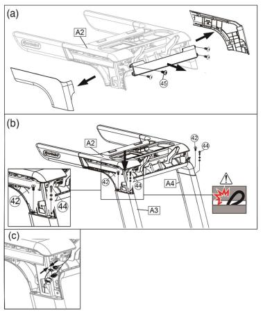
⑥ ハンドルバー(A2)から左右のハンドルカバーと、裏面カバーのネジ[部品 ⑥]を外し、 裏面カバーを取り外します。
