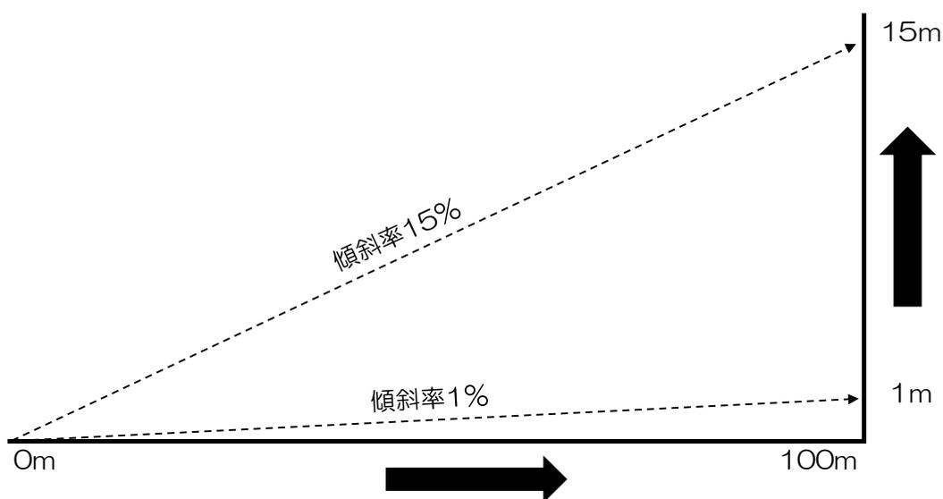
傾斜率とは・・・設定した傾斜率で100m進んだ時の上り勾配の度合いを示す単位
