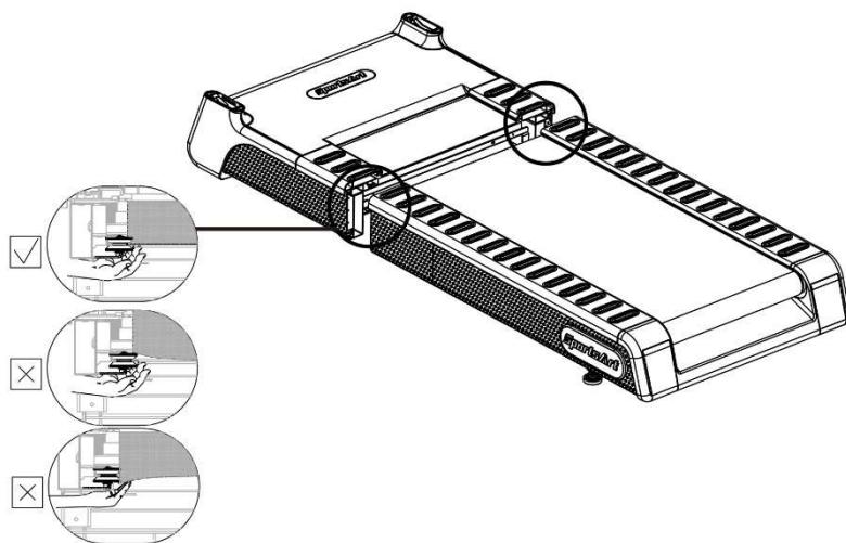
① 左図（✓）のようにランニングベルトが、ベルトのガイドローラーの間に入っているかを確認してください。
