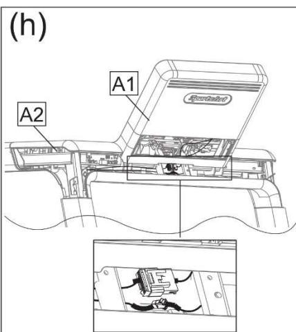
⑬ 表示パネルをしっかりと差し込めたらボルト [部品 43] で固定します。
