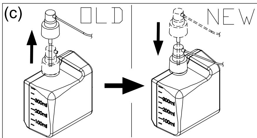
4、古いボトルのノズルを取り外し、新しいボトルに取付けます。
